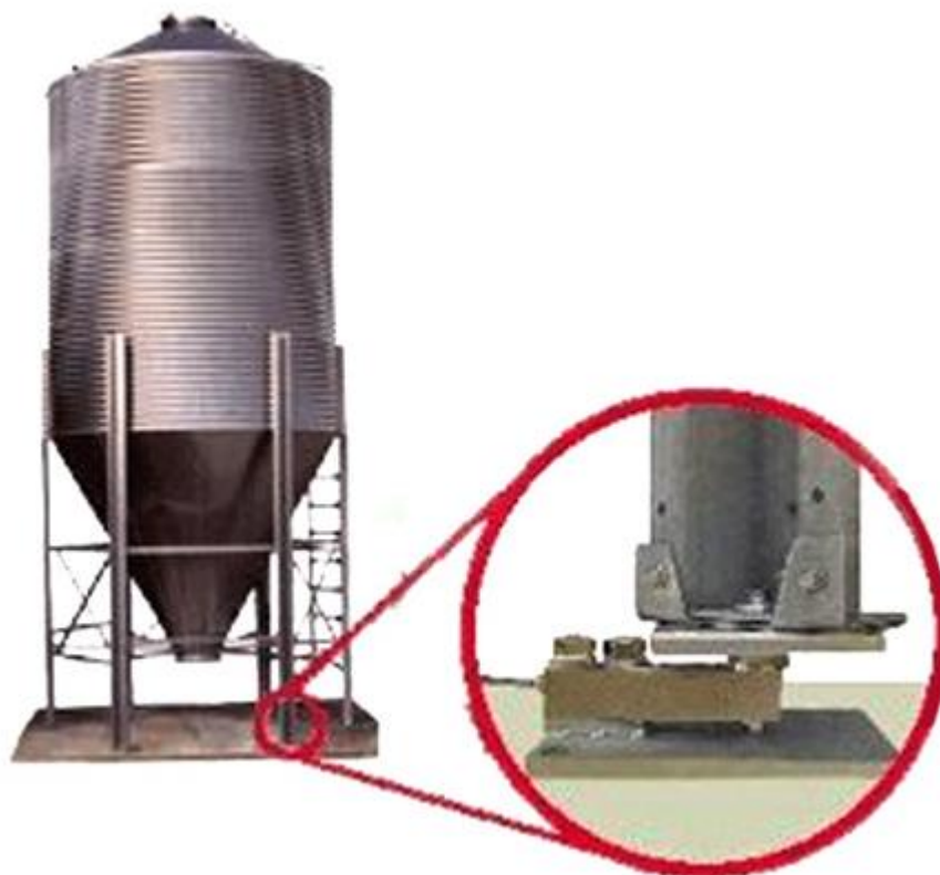
Figura 4 - Medidor de nível por pesagem
