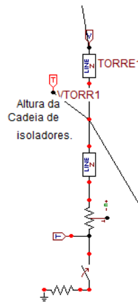
Figura 10 - Representação da estrutura da torre da linha de transmissão empregando Transposed Lines (Clarke type) ,
