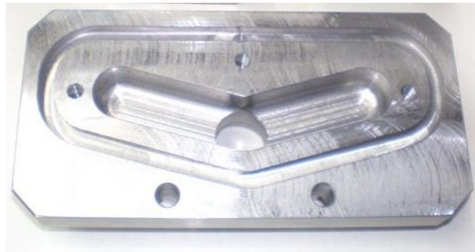
Figura 5 – Peça usinada por Fresadora CNC
