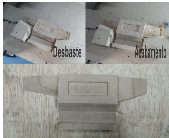
Figura 56 - Usinagem do lado direito na máquina CNC
