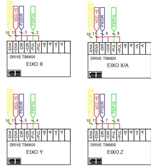
LIGAÇÃO DA CONTROLADORA MACH3 CNC 5 EIXOS AOS DRIVES TB6600
