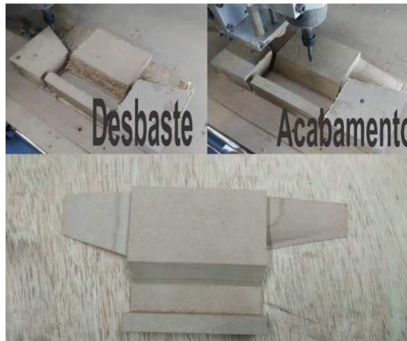
Figura 55 - Usinagem do lado esquerdo na máquina CNC
