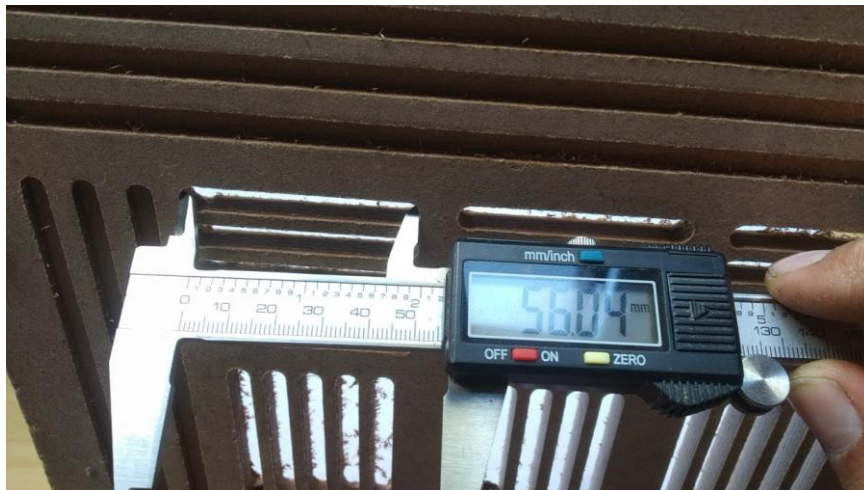
Figura 53 - Medição com o paquímetro
