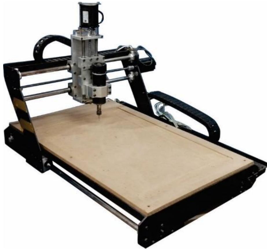
Figura 41 -Estrutura da CNC finalizada
