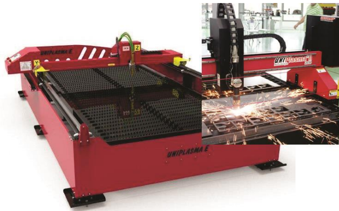
Figura 7 – CNC de corte a plasma de três eixos, para corte de chapas
