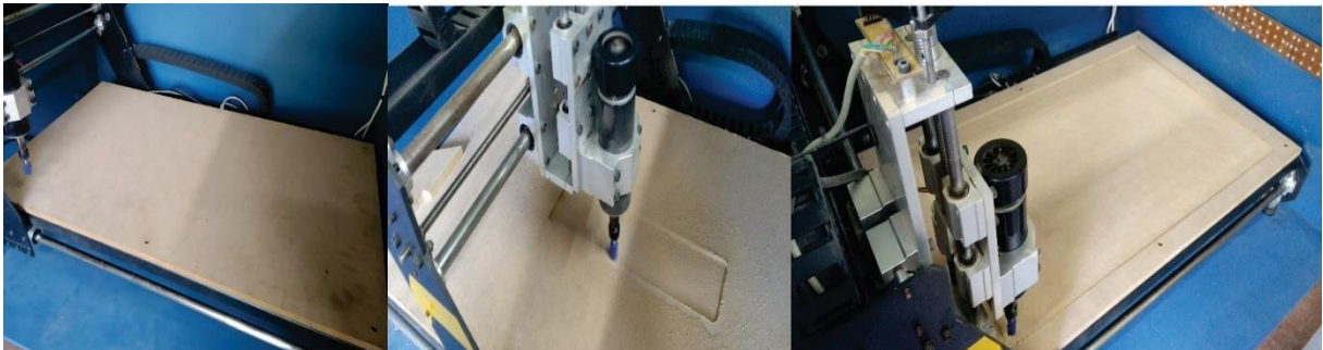
Figura 50 - Processo de aplainamento da mesa
