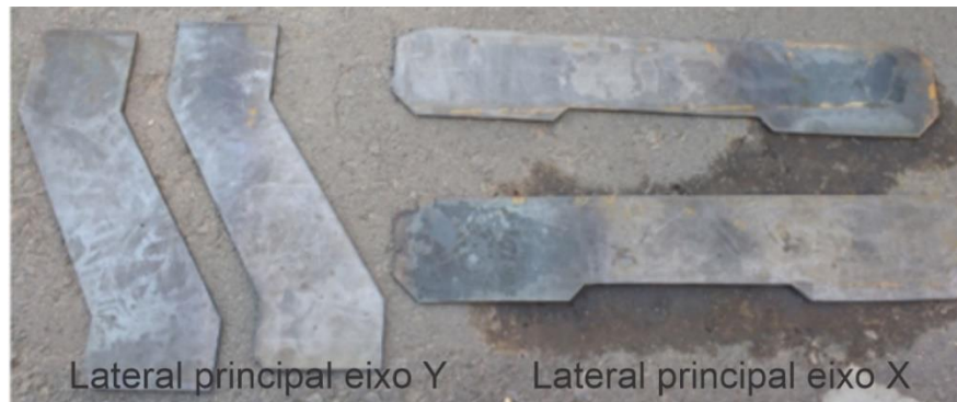
Figura 38 - Laterais da CNC cortadas a plasma
