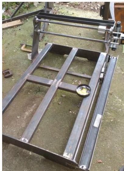
Figura 39 - Estrutura montada provisoriamente para correção mecânica
