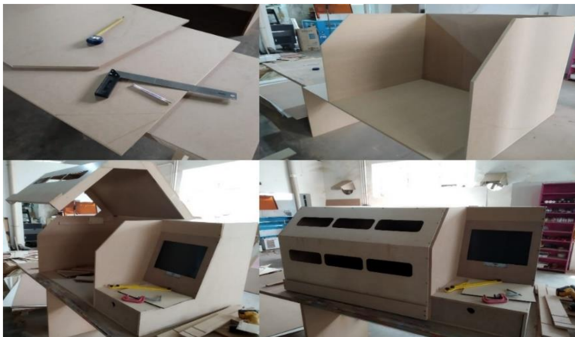
Figura 42 - Processo de montagem da cabine de proteção
