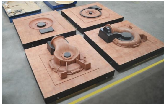
Figura 20 - Modelos de turbinas feito em madeira.
