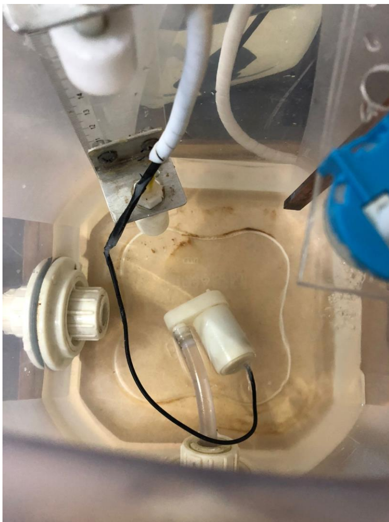
Figura 35 – Resíduos decantados no fundo do reservatório
