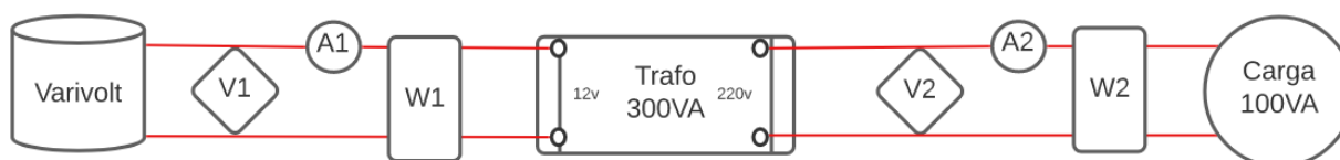
Figura 38 – Diagrama elétrico de ligação transformador.
