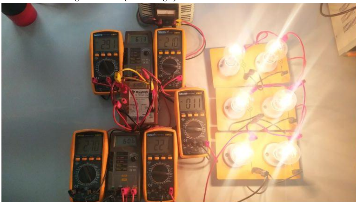
Figura 42 – Layout de ligação como autotransformador.
