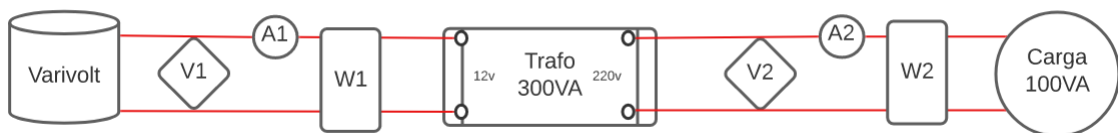
Figura 43 – Diagrama elétrico de ligação transformador.
