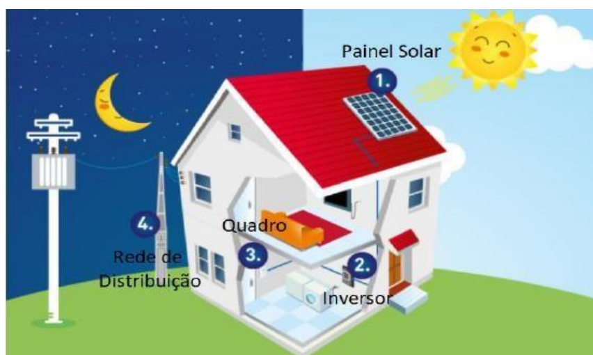
Figura 6 - Estrutura de um sistema fotovoltaico On-Grid
