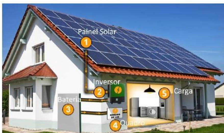
Figura 7 - Estrutura de um sistema fotovoltaico Off-Grid
