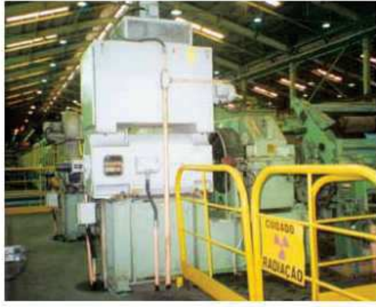
Figura 1 – : Rolo tensor de alimentação de tiras em operação na Usiminas, movimentado por motor de corrente contínua de 325KW.
