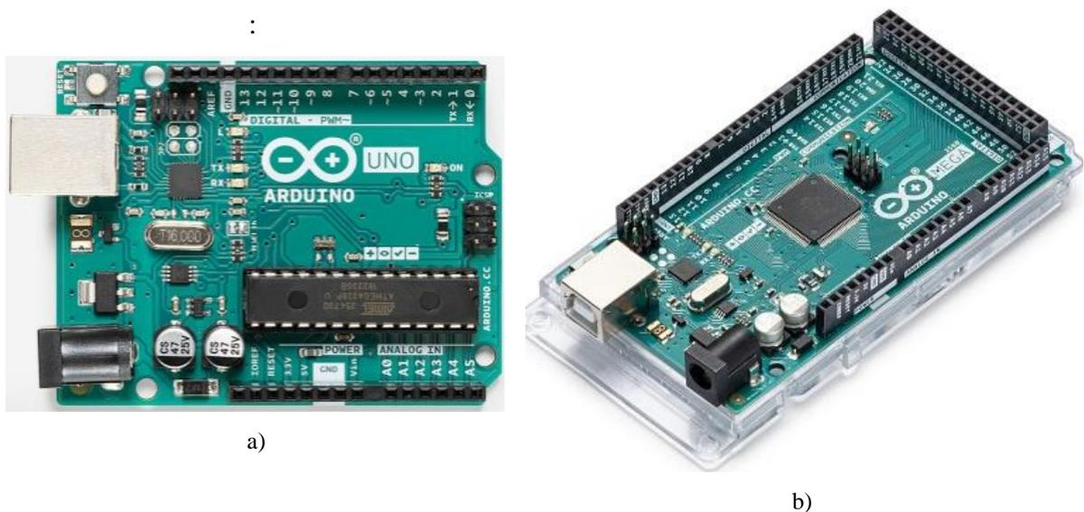
Figura 1: a) Arduino Uno; b) Arduino Mega.
