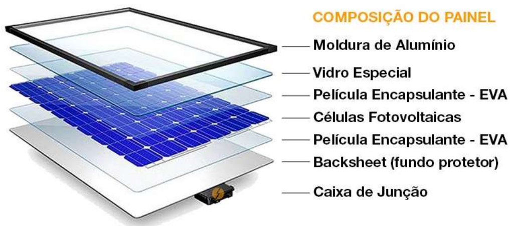
Figura 8 - Apresentação esquemática de um módulo fotovoltaico.
