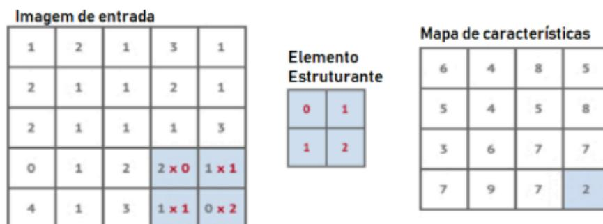
Figura 9 – Exemplo de operação de convolução. Fonte: (DALVI, 2018)
