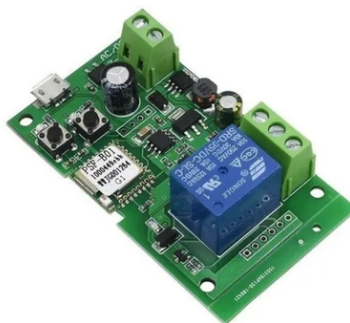
Figura 25 – Módulo relé Sonoff wi-fi Dc5v-12v-32v com função pulso e trava. Fonte: (LIVRE, 2020j).
