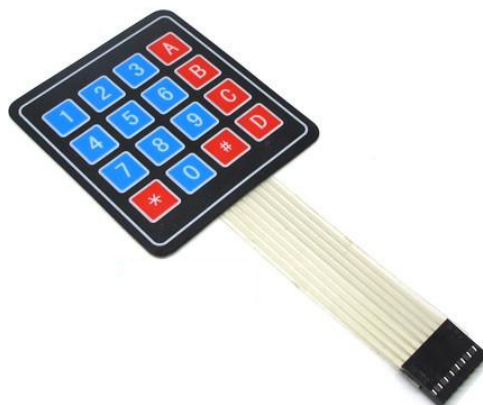
Figura 21 – Teclado de membrana matricial alfanumérico 4x4. Fonte: (LIVRE, 2020k).
