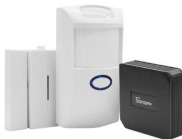
Figura 18 – DW1, Sensor PIR2 e Sonoff 433 RF Bridge . Fonte: (LIVRE, 2020d).
