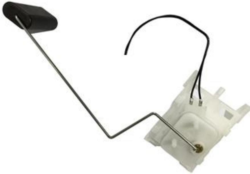
Figura 2 - Sensor de nível automotivo (MIXAUTO, 2019).
