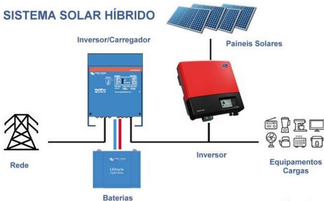
Figura 14 – Representação esquemática de um sistema fotovoltaico híbrido.
