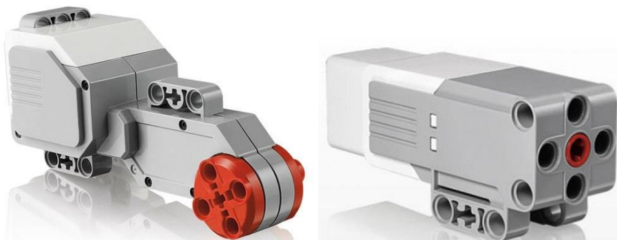
Figura 15: Servo-motor grande (esquerda) e médio (direita) do EV3
